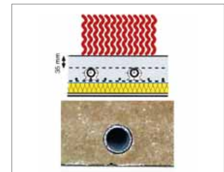
RÖFIX Samorazlivni estrih odlično obda cevi za ogrevanje
